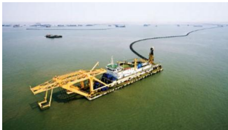
图 3.2-18 绞吸式挖泥船施工示意图
